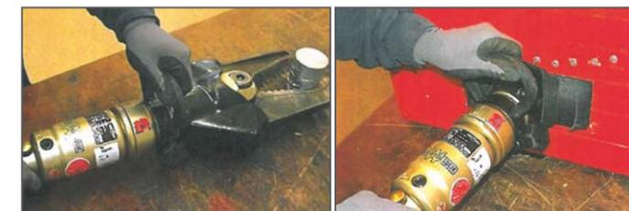
Die Splitterschutzbox der Kreisfeuerwehrzentrale Steinburg im Einsatz bei der Prüfung der hydraulischen Rettungsschere
