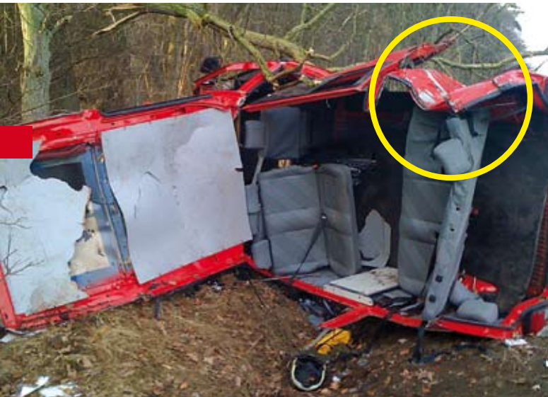
Hauptprallstelle auf der rechten Seite in Höhe des hinteren Rücksitzes
