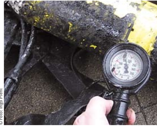
© Foto: Ingo Plehl Das beaufschlagte Atemschutzgerät blieb funktionsfähig. Das Manometer zeigte noch 160 bar an.
