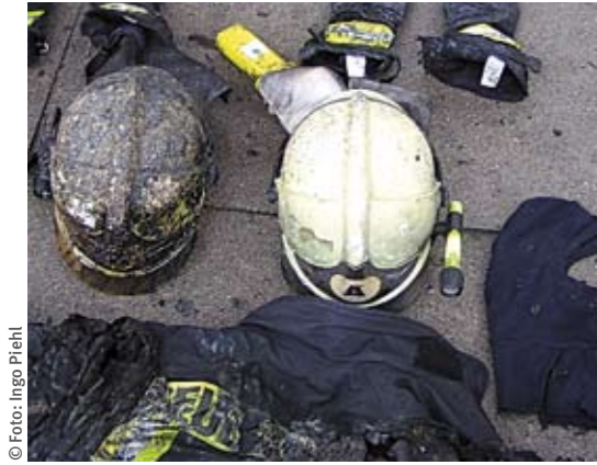
© Foto: Ingo Plehl Feuerwehrhelme, Schutzhandschuhe und Feuerwehr-Überjacke nach Brandeinwirkung
